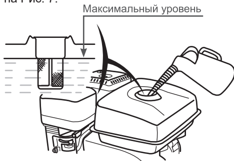
Рис. 7 Максимальный уровень топлива в топливном баке
