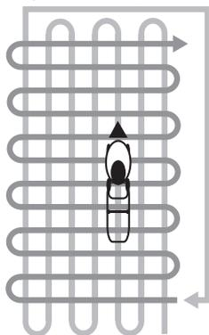
**Рис. 16. Схема скашивания высокой и/или загущенной травы**
