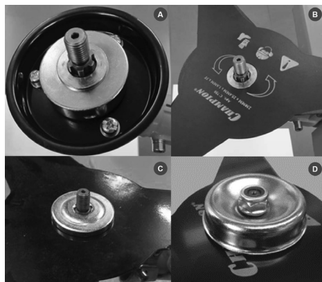
Рис. 7 Установка ножа для травы
