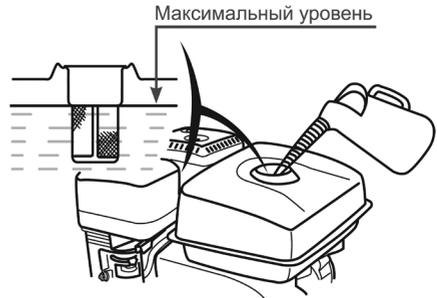
Рис. 5 Максимальный уровень топлива в топливном баке
