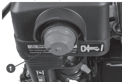
Рис. 26 Расположение ручного топливного насоса
