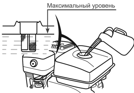
Рис. 20 Максимальный уровень топлива в топливном баке
