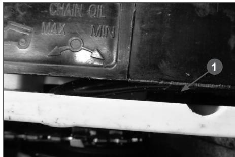
Рис. 8 Винт регулировки подачи масла
