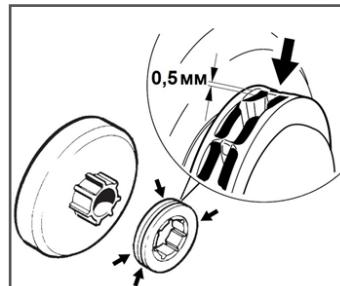
Рис. 27 Максимально допустимая глубина износа зубьев ведущей звездочки
