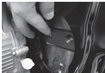
Рис. 23 Установка ножа измельчителя
