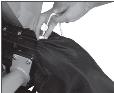
Рис. 4 Установка мешка для сбора продуктов измельчения
