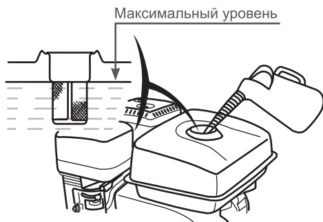
Рис. 8 Максимальный уровень топлива в топливном баке
