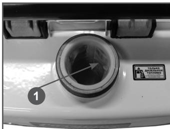
Рис. 8 Максимальный уровень топлива в топливном баке
