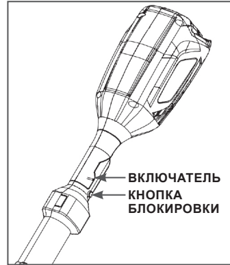
Рис. 9 Расположение органов управления на задней рукоятке
