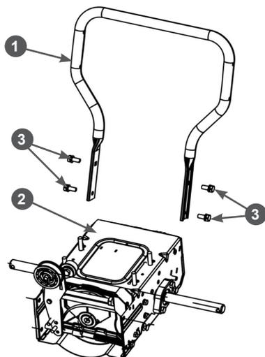
**Рис. 4 Установка стойки рукояток ST661**
