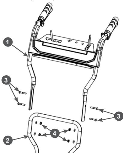
**Рис. 5 Установка рукояток ST661**
