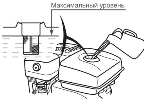
**Рис. 19 Максимальный уровень топлива в топливном баке**
