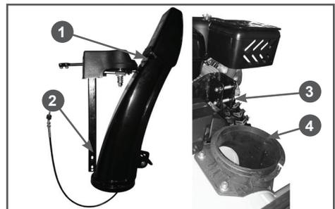
**Рис. 14 Установка желоба выброса снега ST661**
