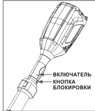
Рис. 9 Расположение органов управления на задней рукоятке
