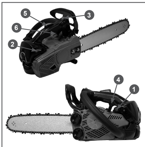
Рис. 10 Органы управления, необходимые для запуска бензопилы
