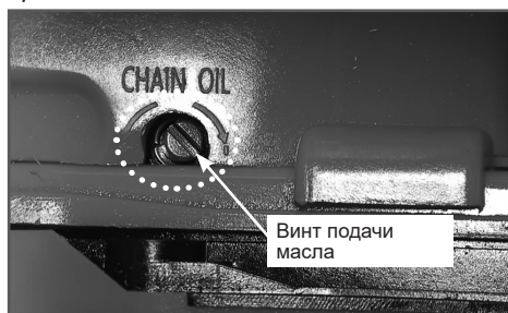
Рис. 11 Расположение регулировочного винта подачи масла
