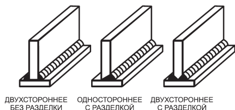
Рис. 8 Виды тавровых соединений
