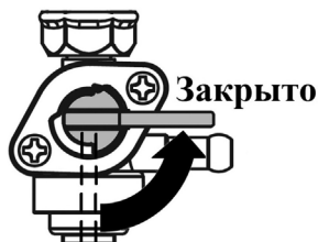
Рис. 7 Топливный кран закрыт
