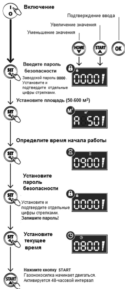
Рис. 17 Алгоритм настройки автоматического режима работы газонокосилки
