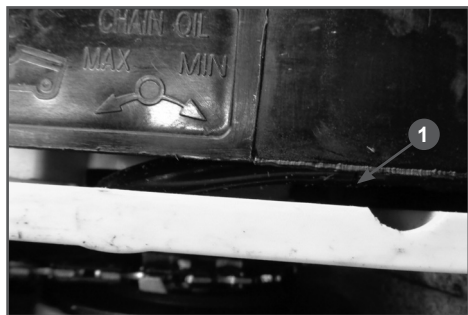
Рис. 8 Винт регулировки подачи масла
