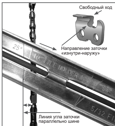
Рис. 22 Расположение линии угла заточки
