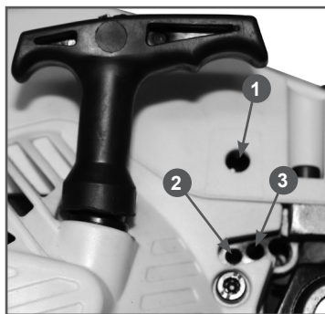
Рис. 20 Винты регулировки карбюратора
