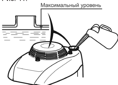
Рис. 11 Максимальный уровень топлива в топливном баке
