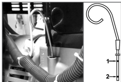
Рис. 8 Проверка уровня масла в картере
