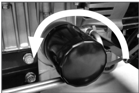
Рис. 15 Замена масляного фильтра
