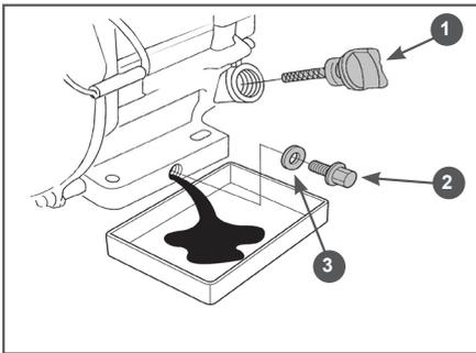
**Рис. 13** Замена моторного масла
