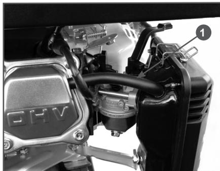
Рис. 12 Трубка системы вентиляции картера
