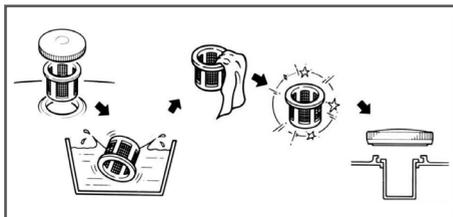
**Рис. 16 Обслуживание сетчатого фильтра в горловине топливного бака**
