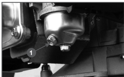
Рис. 20. Слив топлива с поплавковой камеры карбюратора
