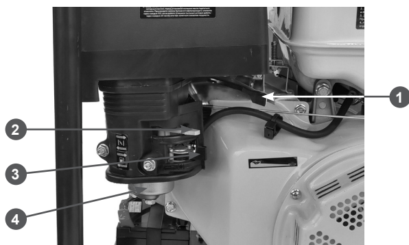
Рис. 4 Органы управления двигателя (вид на карбюратор)
