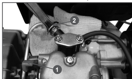
Рис. 15 Удаление воздуха из топливной системы
