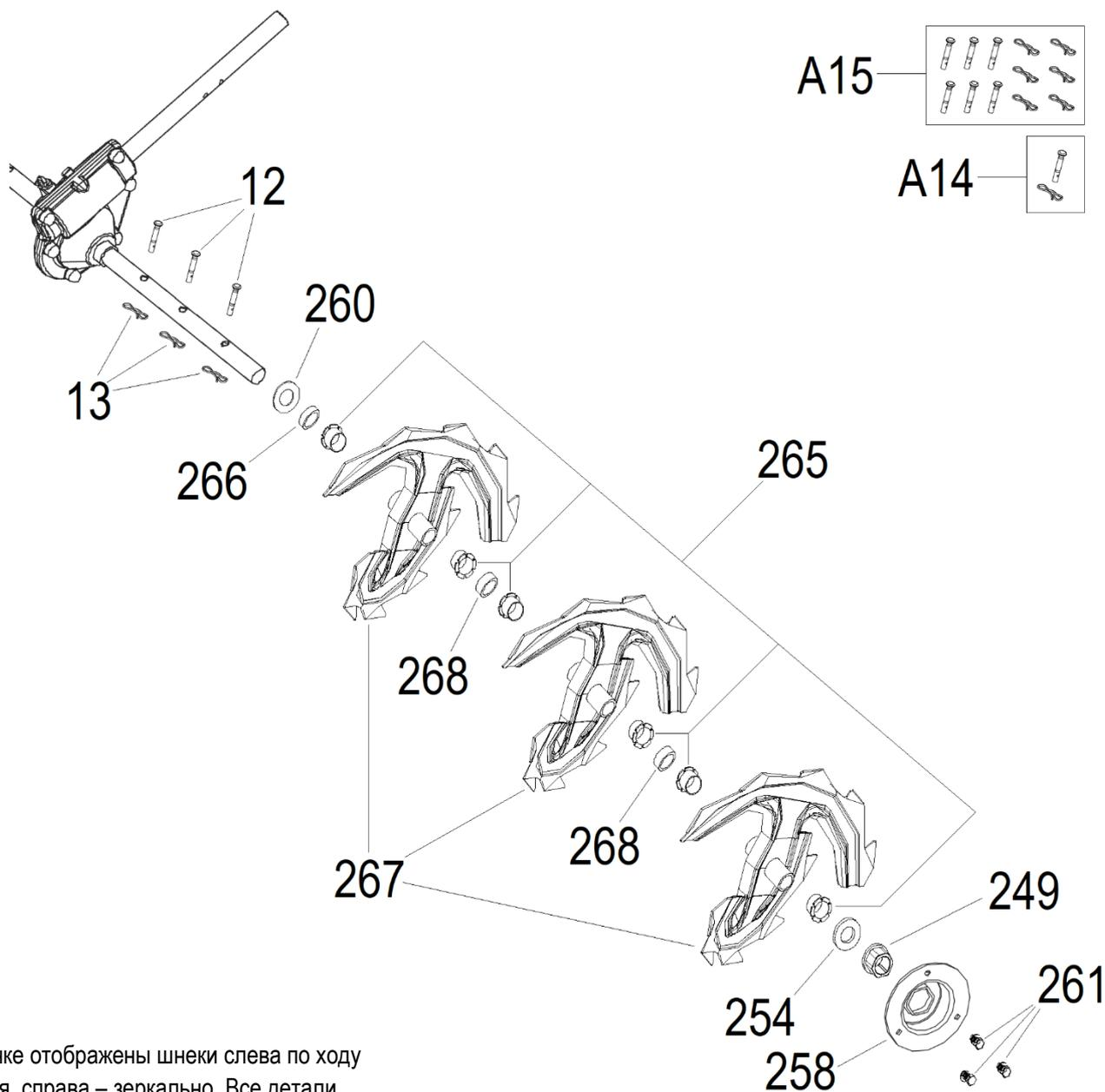
На рисунке отображены шнеки слева по ходу движения, справа – зеркально. Все детали, кроме шнеков, одинаковые.
