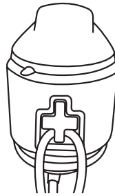
Рис. 7. Крепление кабеля удлинителя
