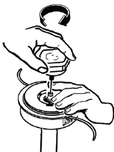
Рис. 16. Закручивание винта крепления триммерной головки
