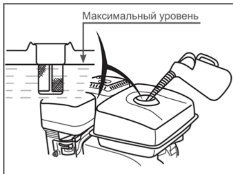
Рис. 7 Максимальный уровень топлива в топливном баке
