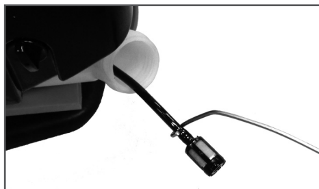
Рис. 15 Извлечение топливного фильтра
