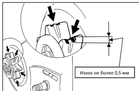
Рис.16 Проверка износа звездочки
