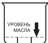
Рис. 23 Уровень масла в масляной ванне воздушного фильтра
