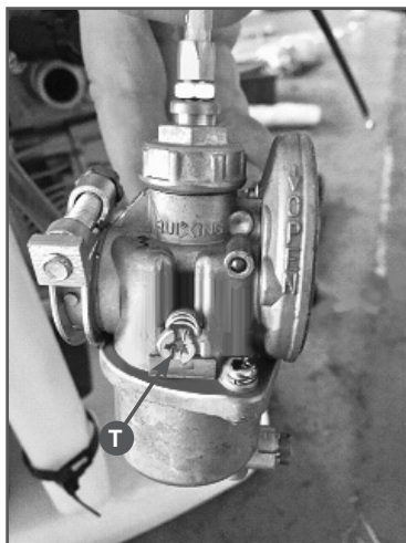
Рис. 16 Расположение винтов регулировки карбюратора
