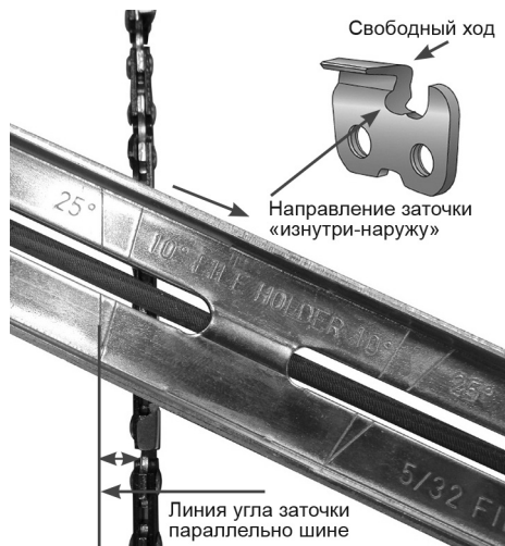
Рис. 15 Определение угла заточки
