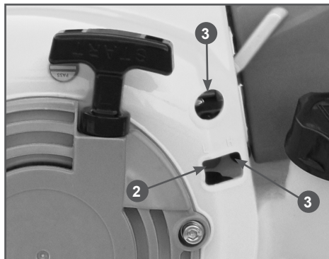
Рис.8 Винты регулировки карбюратора 1 - винт «Т», 2 – винт «L», 3 - винт «Н»
