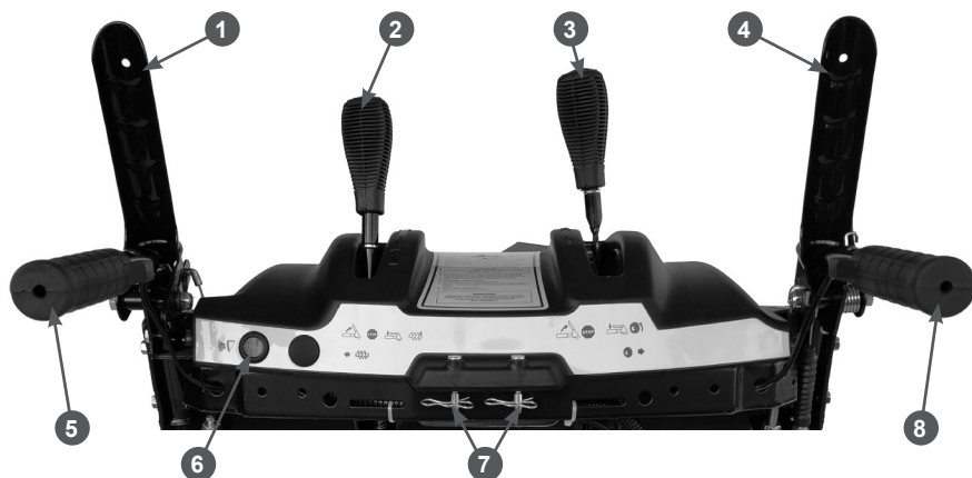
Рис. 2 Панель управления (вид со стороны оператора)
