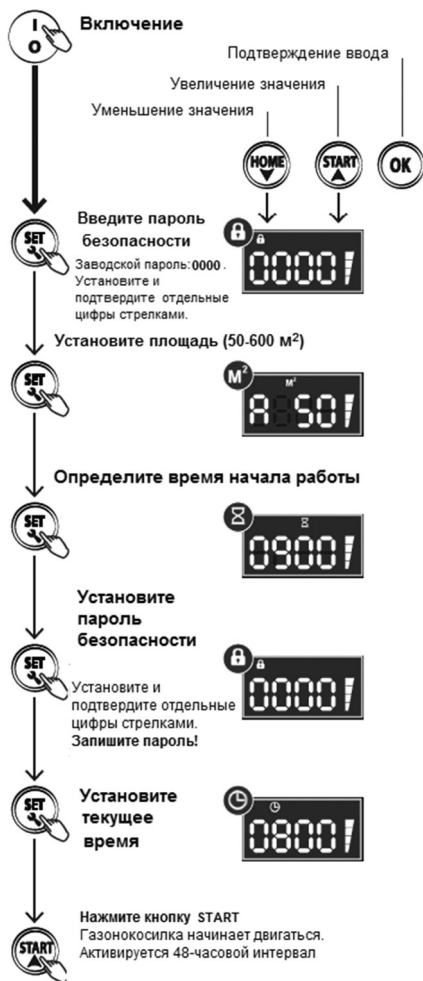
Рис. 17 Алгоритм настройки автоматического режима работы газонокосилки
