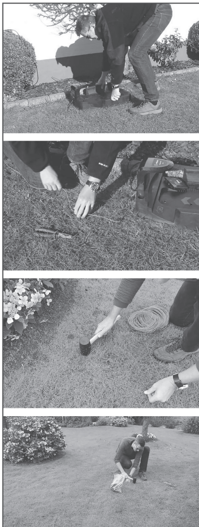
Рис. 7 Последовательность действий при установке зарядной станции
