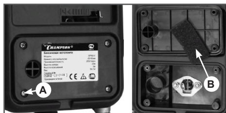
Рис. 10 Извлечение воздушного фильтра
