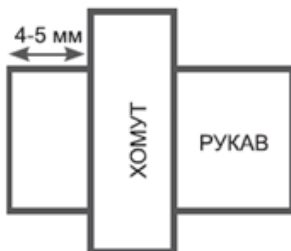
Рис. 6 Расположение хомута на рукаве
