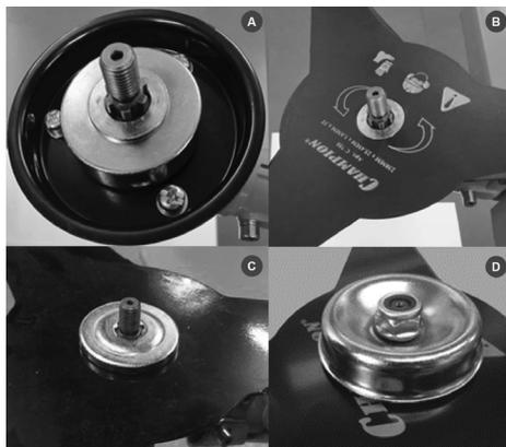
**Рис. 7 Установка ножа для травы**
