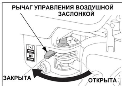
Рис. 14 Рычаг управления воздушной заслонкой (вид сверху)
