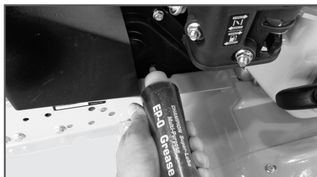
Рис. 25 Добавление смазки в редуктор
