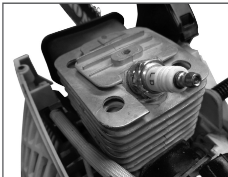
Рис. 28 Охлаждающие ребра цилиндра
