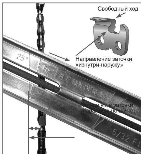
Рис. 22 Расположение линии угла заточки
