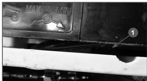
Рис. 8 Винт регулировки подачи масла
