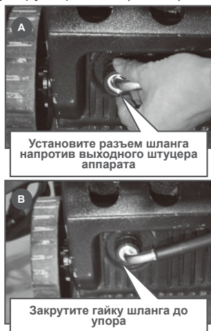
Рис. 4 Подключение шланга высокого давления к аппарату
