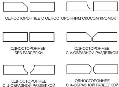
Рис. 7 Виды стыковых соединений
