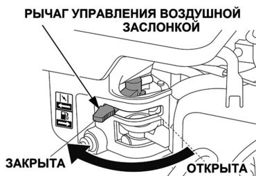
Рис. 9 Воздушная заслонка закрыта
