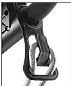
Рис. 10 Фиксация кабеля удлинителя на рабочей рукоятке
