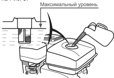
Рис. 9 Максимальный уровень топлива в топливном баке
