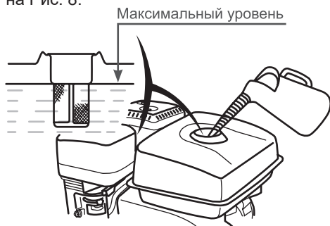
Рис. 8 Максимальный уровень топлива в топливном баке
