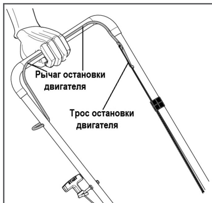
Рис. 7 Проверка работы троса остановки двигателя
