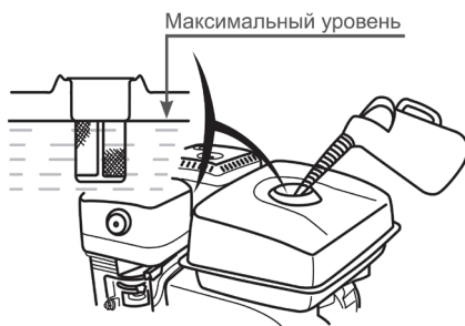
Рис. 20 Максимальный уровень топлива в топливном баке
