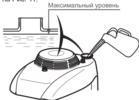
Рис. 11 Максимальный уровень топлива в топливном баке
