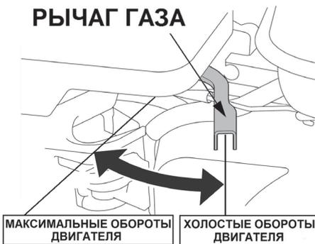
Рис. 16. Рычаг топливного крана
