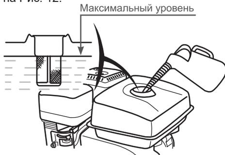
**Рис. 12. Максимальный уровень топлива в топливном баке**
