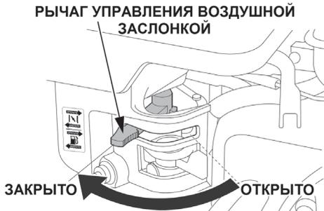
Рис. 15. Рычаг управления воздушной заслонкой
