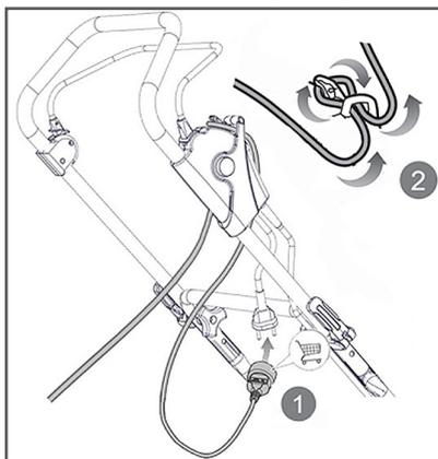
Рис. 8 Фиксация кабеля удлинителя на рабочей рукоятке.
