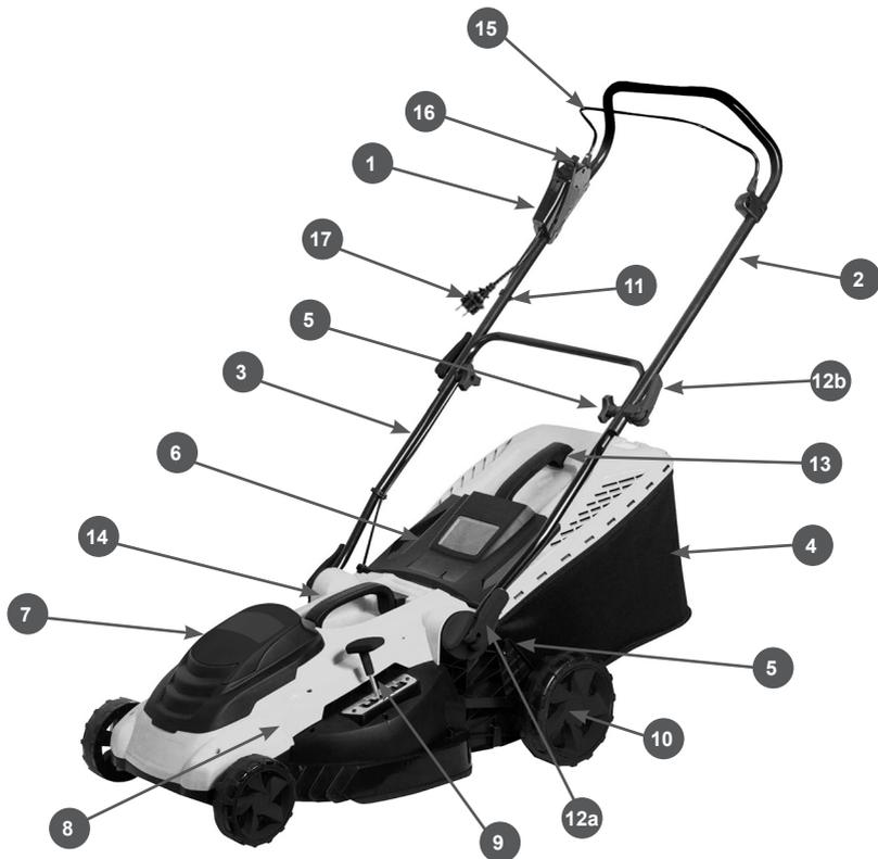
Рис. 1 Основные узлы и органы управления газонокосилки EM4118
