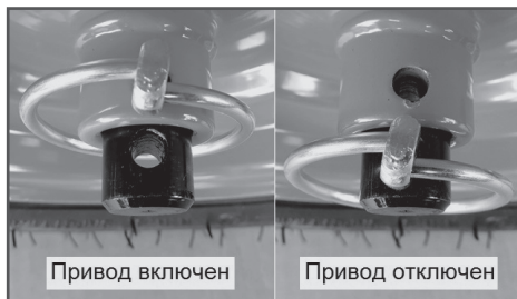
Рис.10 Перестановка шплинта на левом колесе
