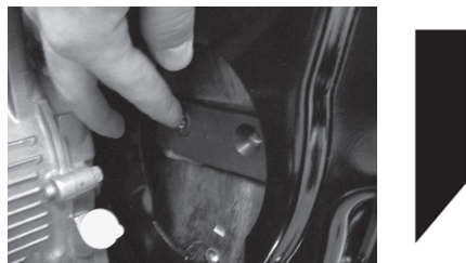
Рис. 23 Установка ножа измельчителя
